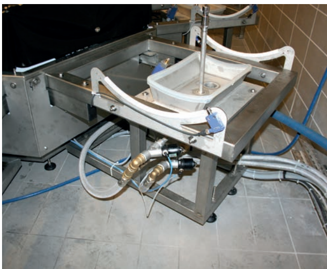
LAVEUR BARRIQUES ROTATIF Château Beychevelle (Saint-Julien-Beychevelle) INSTALLATION 2016
