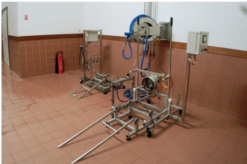
LAVEURS BARRIQUES. 1 LAVEUR BASSE PRESSION, 1 LAVEUR HAUTE PRESSION (TÊTE MOOG) Château Montrose (Saint-Estèphe) INSTALLATION 2012
